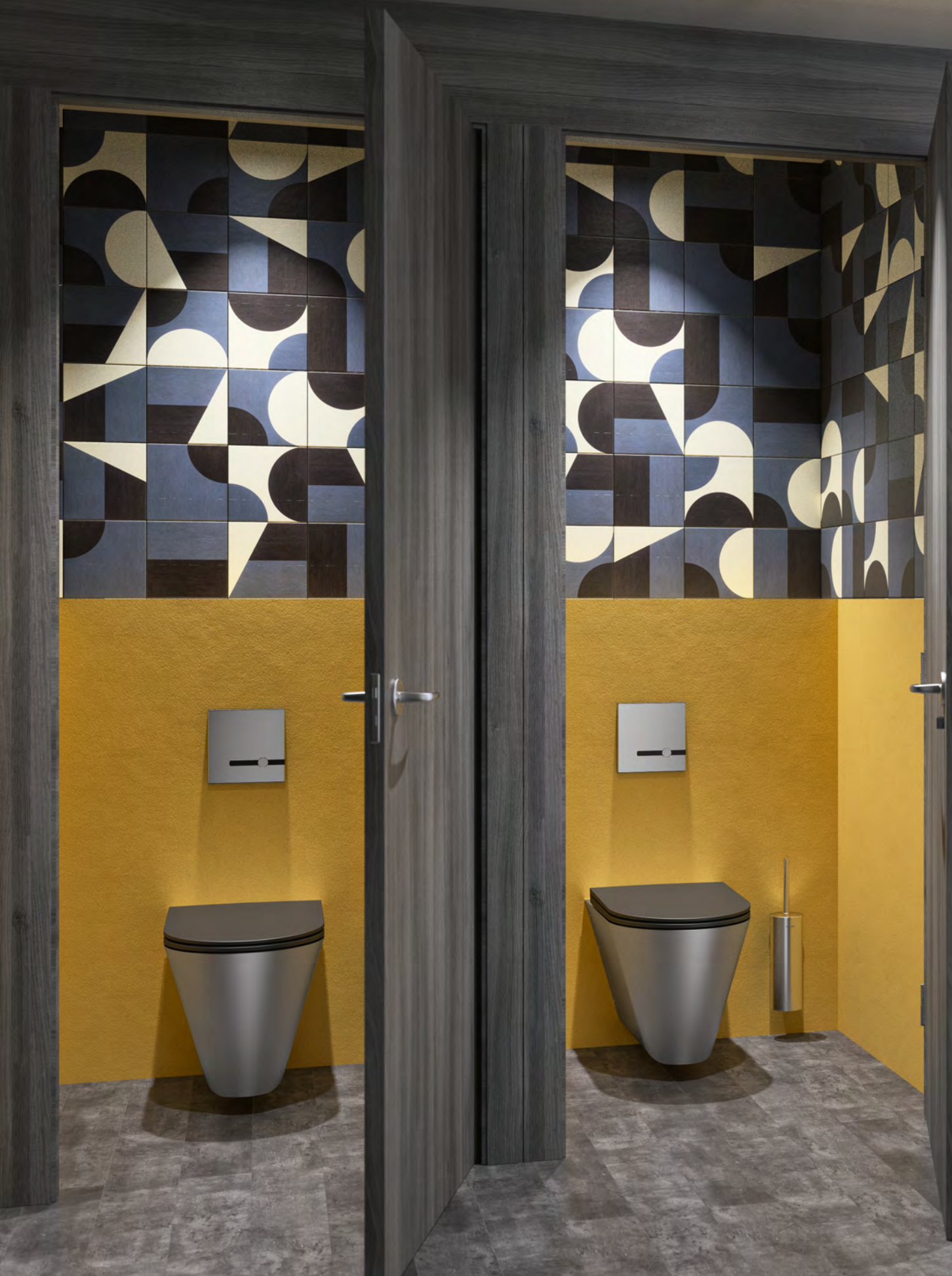
Elektronischer WC-Druckspüler für Unterputzmontage TEMPOMATIC mit dualer Steuerung 464SBOX + 464000 - WC S21 S wandhängend 110310 WC-Sitz schlankes Design schwarz 102819 - WC-Bürstengarnitur für Wandmontage mit Deckel 4051S
