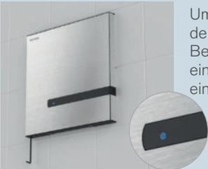
Um Bluetooth® zu aktivieren: den Knopf links unter der Betätigungsplatte mit Hilfe eines Innensechskantschlüssels eindrücken. Erst loslassen, wenn die blaue Leuchtanzeige erscheint. Die blaue LED blinkt.
