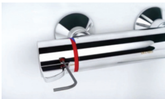
Entriegelung des Temperaturanschlags zur Durchführung einer thermischen Desinfektion: Einfach den roten Knopf mit einem spitzen Gegenstand eindringen
